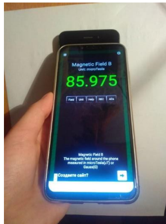
Рис. 3.4. Вимірювання електромагнітного випромінювання у верхній частині мобільного телефону ZTE Blade A601
