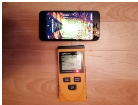
Рис. 3.7. Вимірювання рівня електромагнітного випромінювання за допомогою вимірювача «Ккmoon GM 3120»
