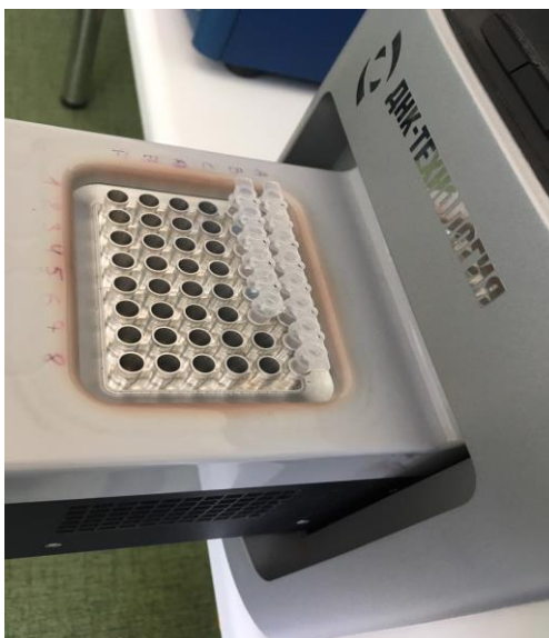
Рис. 2.4. Внесення планшету до ампліфікатора
