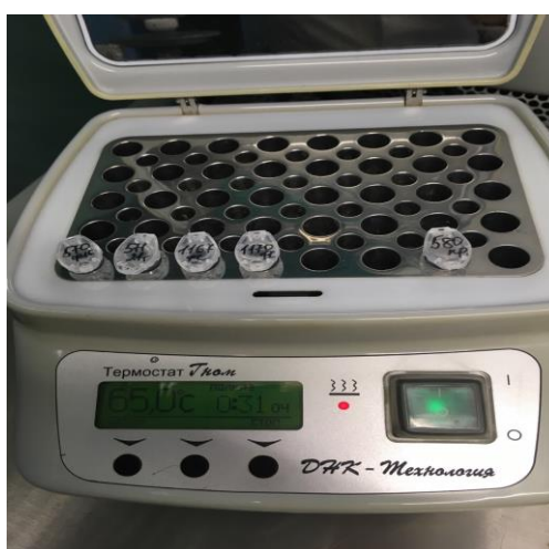
Рис. 2.1. Спеціалізований термостат для ПЛР
