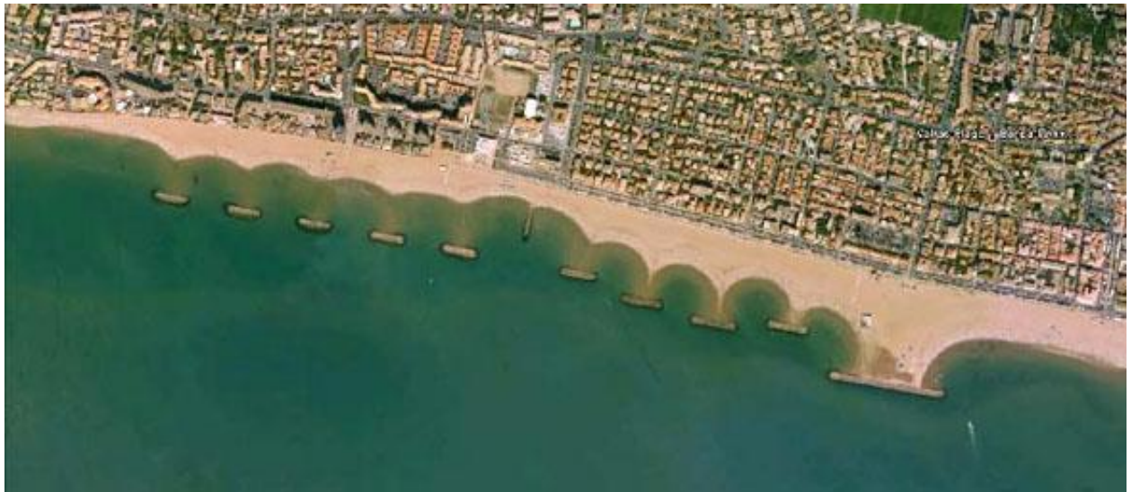
Мал. 7.1 та мал. 7.2 Розвиток берегозахисних систем бухтового типу і наочне відображення процесу накопичення наносів.
