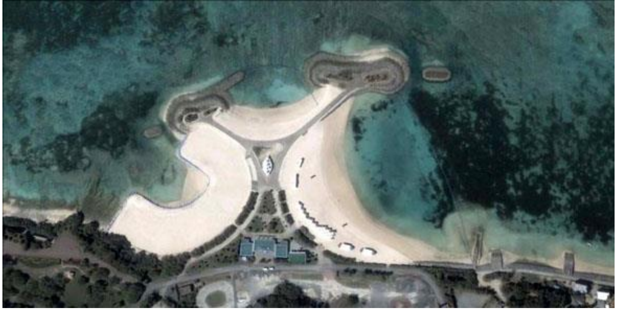
Мал. 6.2 Окінава, Японія. Формування локальної рекреаційної пляжної зони за допомогою точкових штучних островів, з'єднаних з штучним мисом хвилеломами і подальшим відсипанням пляжеутворюючого матеріалу.
