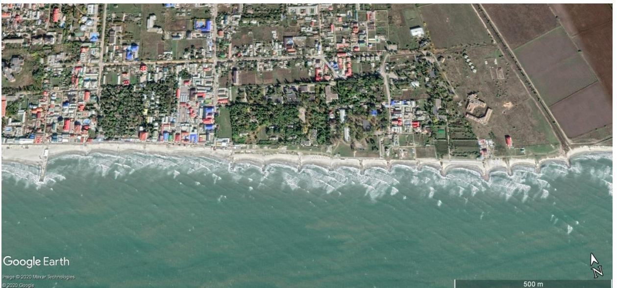
Мал. 5.1. Система залізобетонних бун в межах берегової зони СМТ Залізний Порт.
