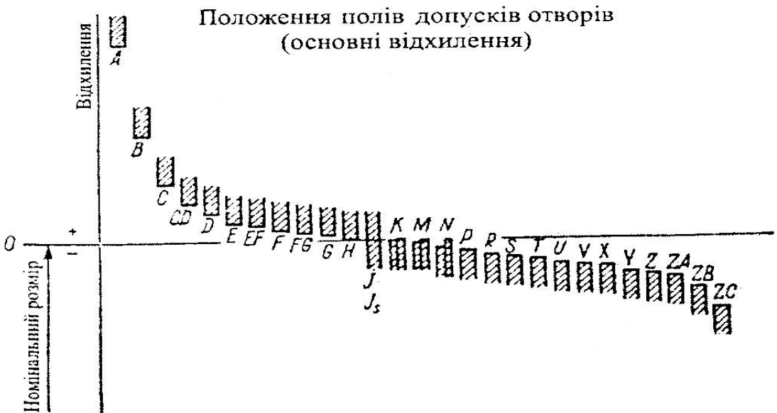
Рис. П.4.1. Положення полів допусків (основні відхилення) валів та отворів.
