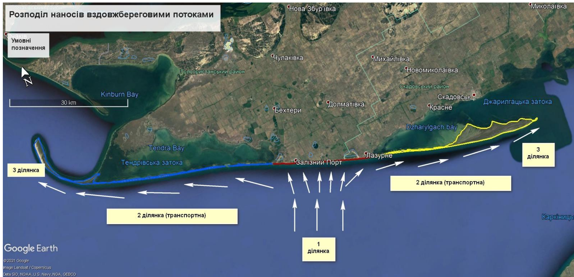
Рисунок Б 1 – Розподіл наносів вздовжбереговими потоками (авторська розробка)
