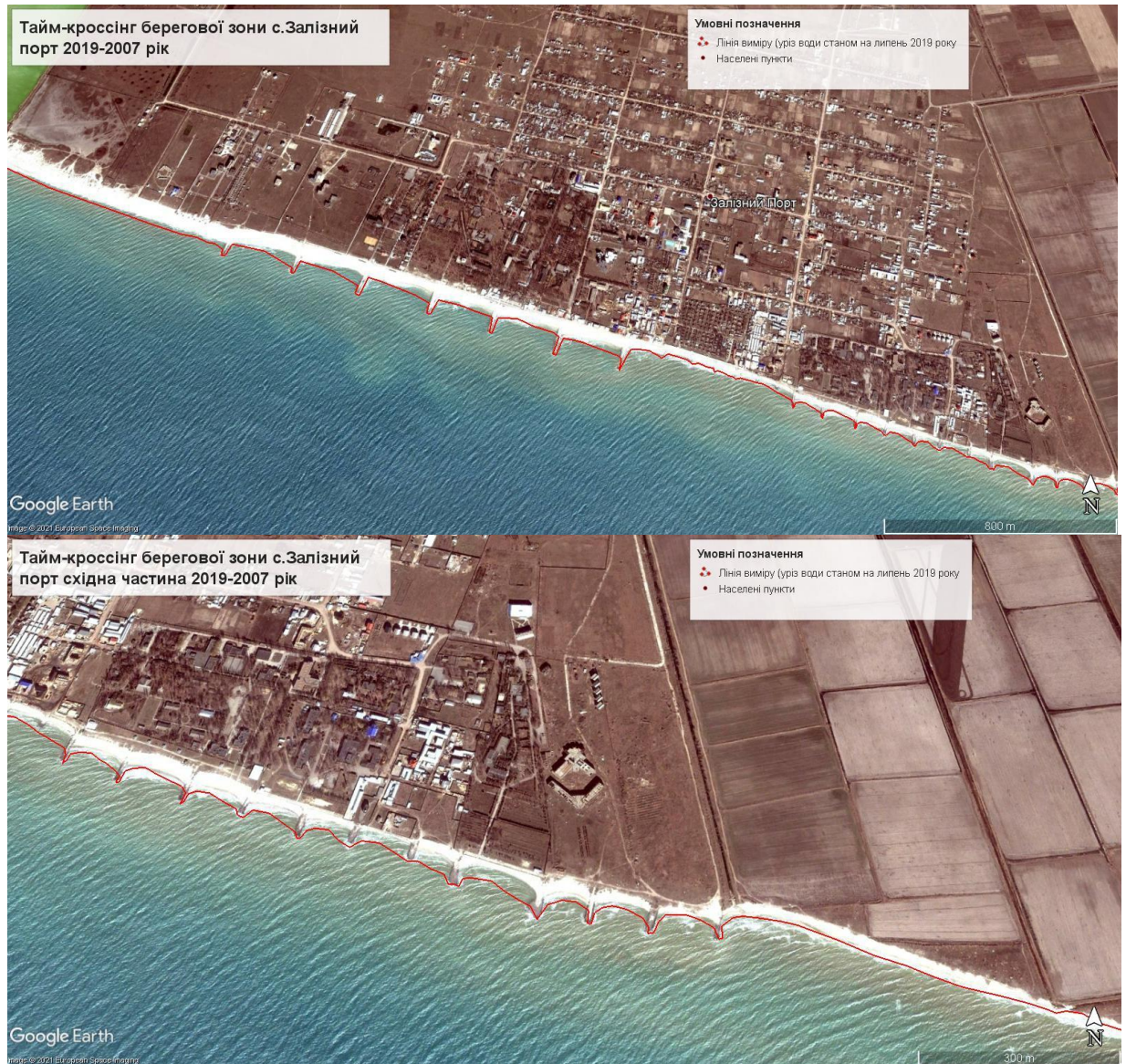
Рисунок Д 1 – тайм-кроссінг берегової зони (Залізний порт східна і західна частини 2019-2007 рік) (авторська розробка)
