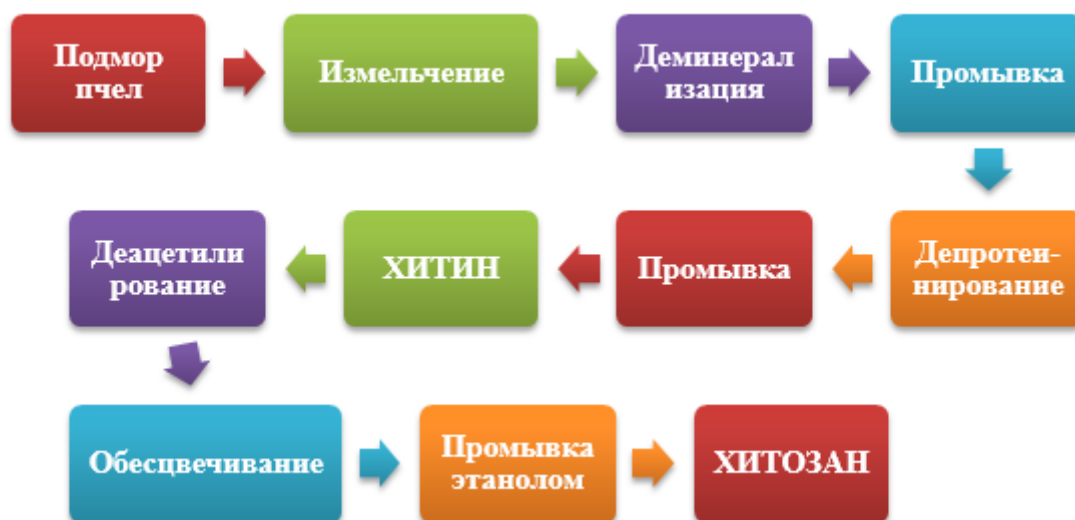
Рисунок 1. Общая схема получения хитин и хитозана
