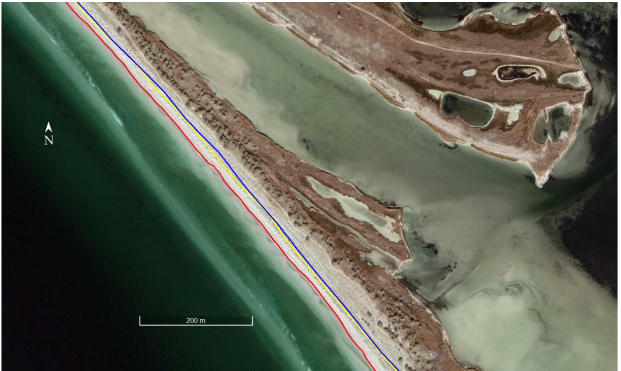
Рис. 2.4. Приклад фіксації положення берегової смуги в межах середньої частини Сухої коси: жовта смуга – 2005 рік; синя смуга – 2014 рік; червона смуга – 2019 рік (розроблено на базі ресурсу Google Earth ).
