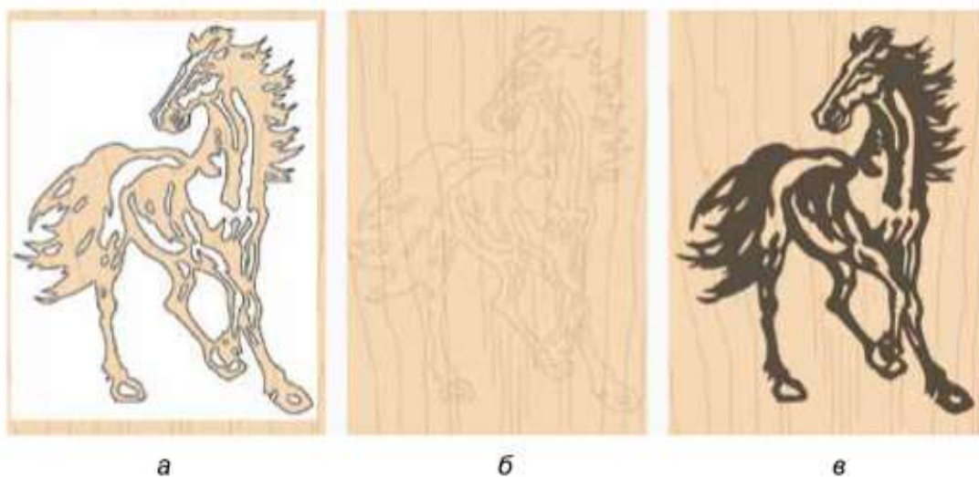
Рисунок А.7 - Розмічання за трафаретом: а – трафарет, б – зображення контурів на заготовці, в – випалене зображення
