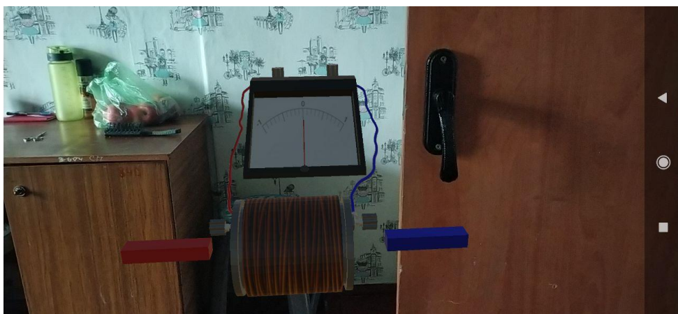
Рисунок 3.10 Явище електромагнітної індукції
