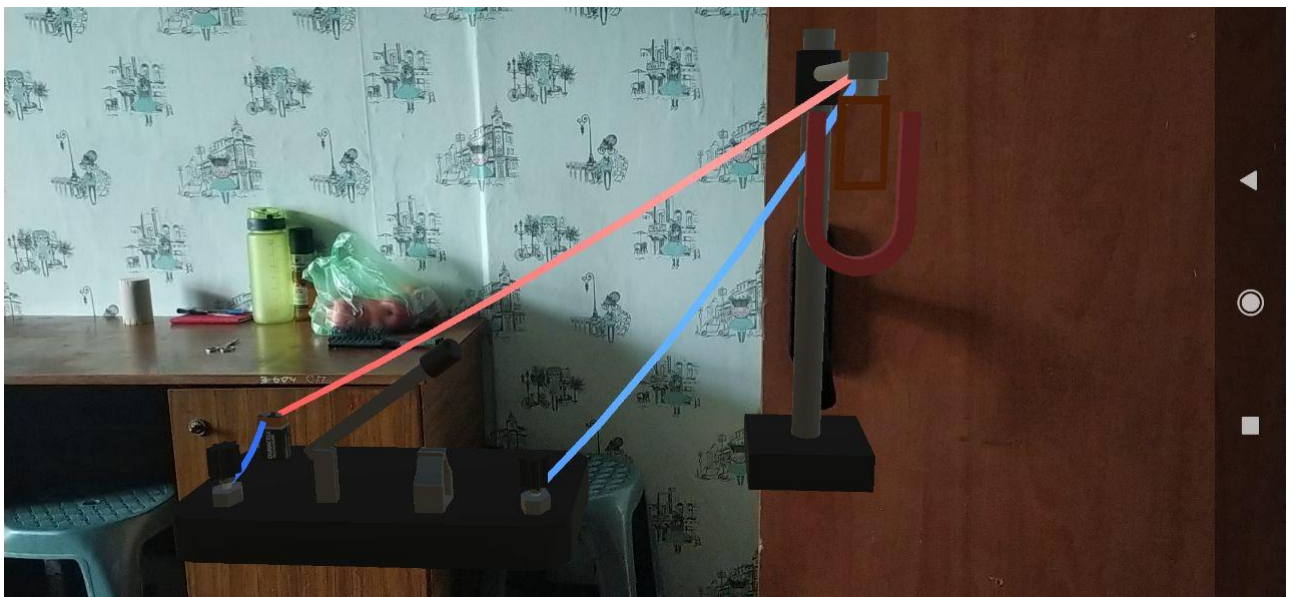
Рисунок 3.9 Обертання рамки у магнітному полі
