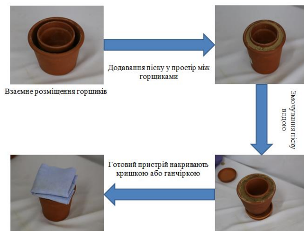
Рис.1. Конструкція та етапи створення пристрою типу «горщик у горщику»
