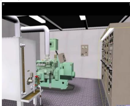
Рис. 2. Помещение аварийного генератора
