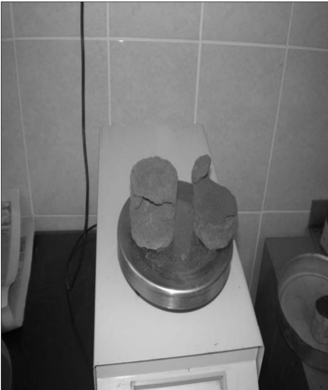
Рис. 2. Дослідний зразок ґрунту після дії повітряно-піщаного потоку.
