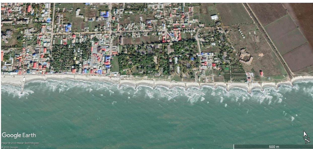
Рис. М. 4.1. Система насипних шпор в межах берегової зони Залізного Порту.
