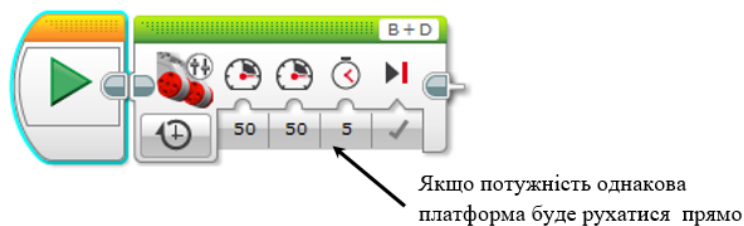
Рис. 3.5. Написання блоку запуску моторів за 5 секунд в середовищі Lego Mindstorms
