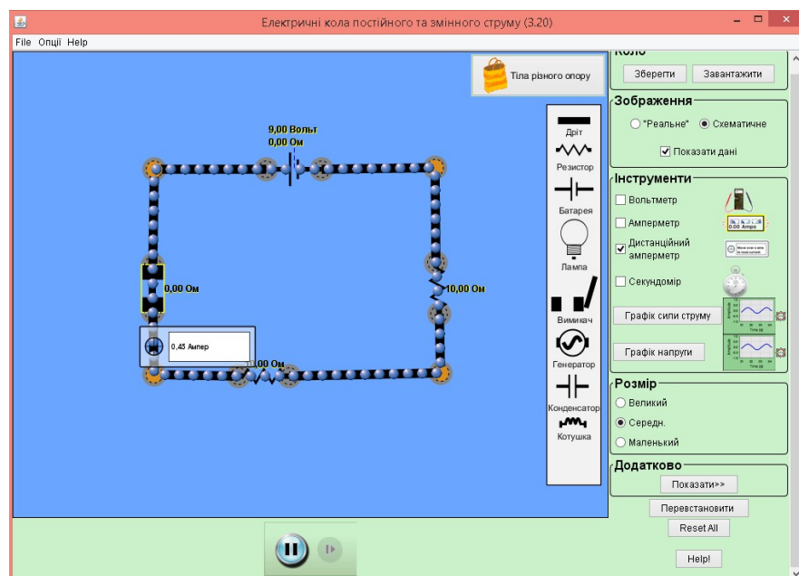
Рис. 2.17 Вимірювання сили струму між джерелом струму і вимикачем
