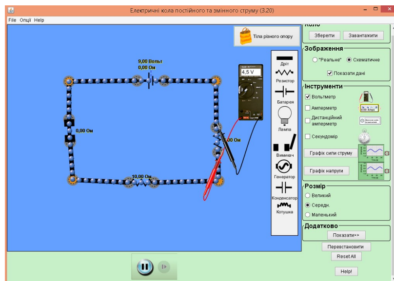
Рис. 2.19 Вимірювання напруги на першому резисторі
