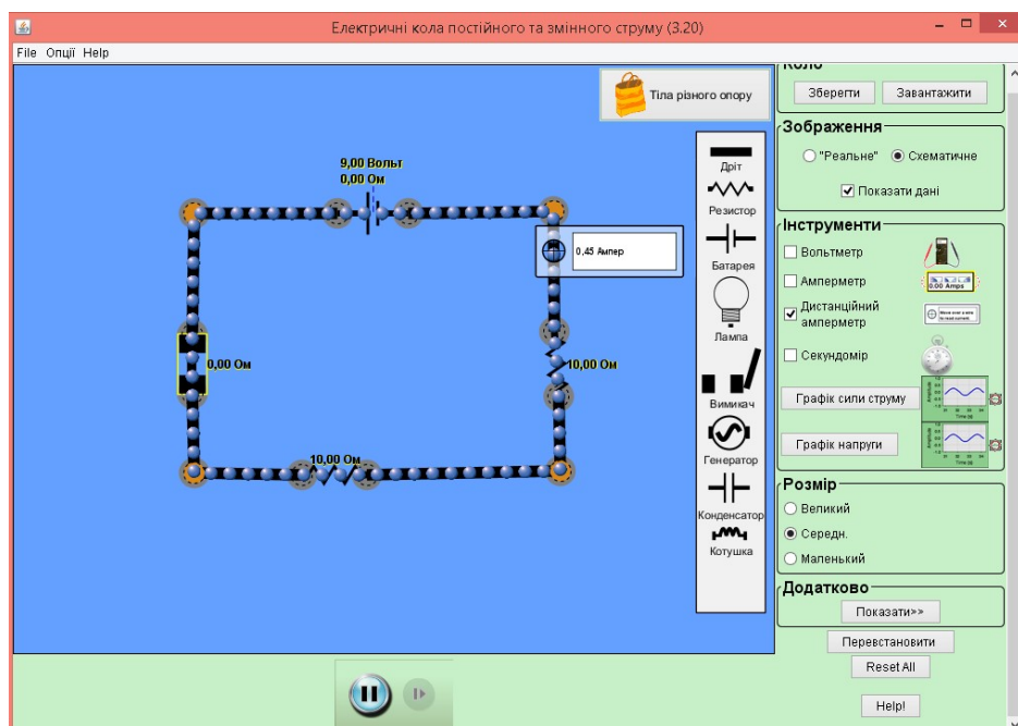
Рис. 2.15 Вимірювання сили струму між джерелом струму і першим резистором
