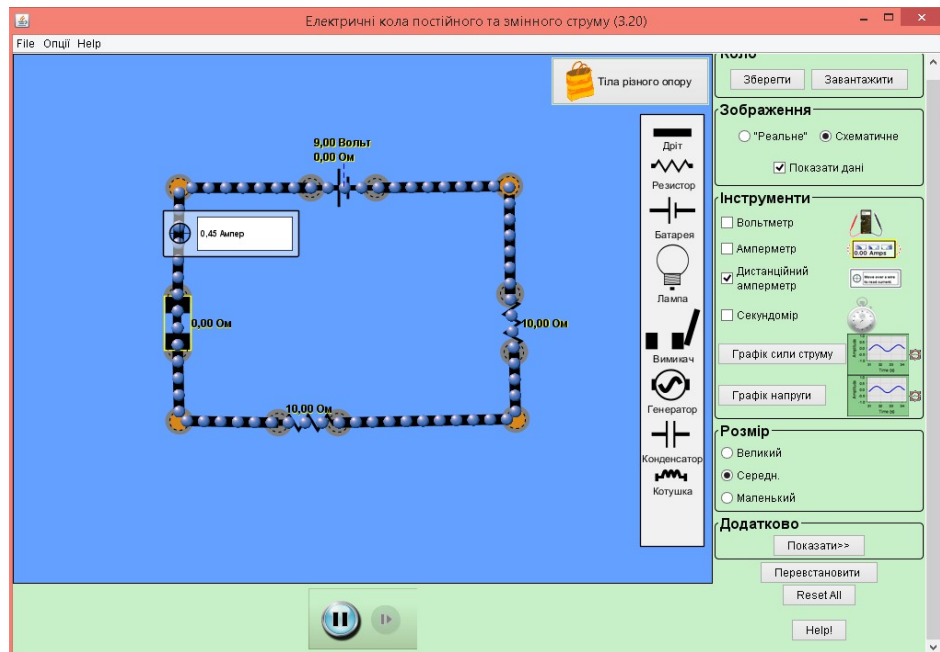
Рис. 2.16 Вимірювання сили струму між вимикачем та другим резистором
