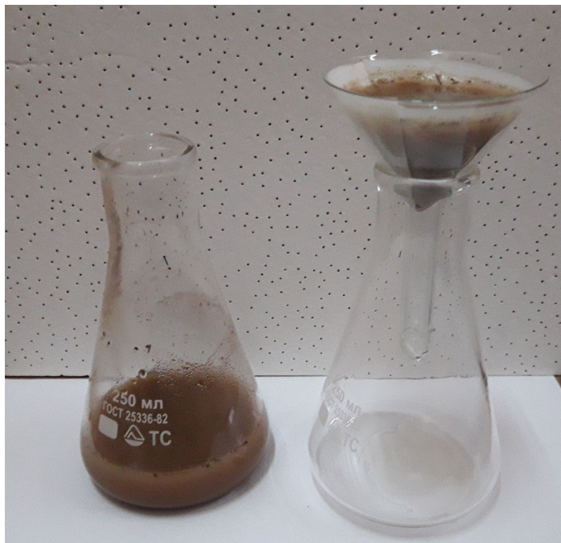
Рис. 2 Фільтрування водної витяжки з ґрунту.
