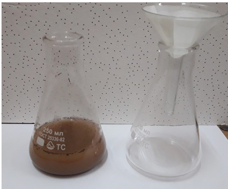
Рис. 1 Приготування водної витяжки з ґрунту.
