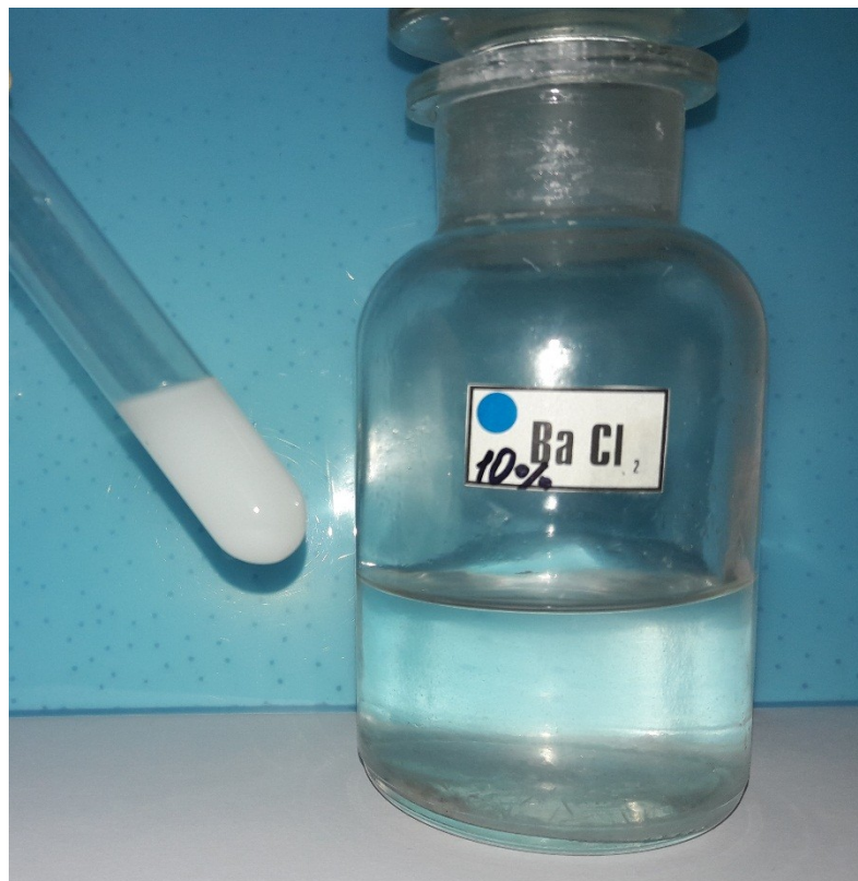
Рис. 3 Утворення осаду BaSO 4 в одному із зразків водної витяжки.
