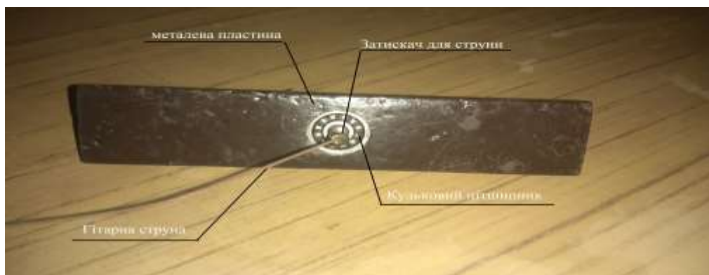
Рис. 3.3. Схема підвісу маятника
