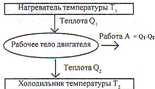
Рис. 2.6. Принцип роботи теплової машини
