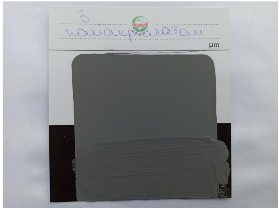
Рисунок 3.8. Нанесена на картку паста, на основі поліакрилату
