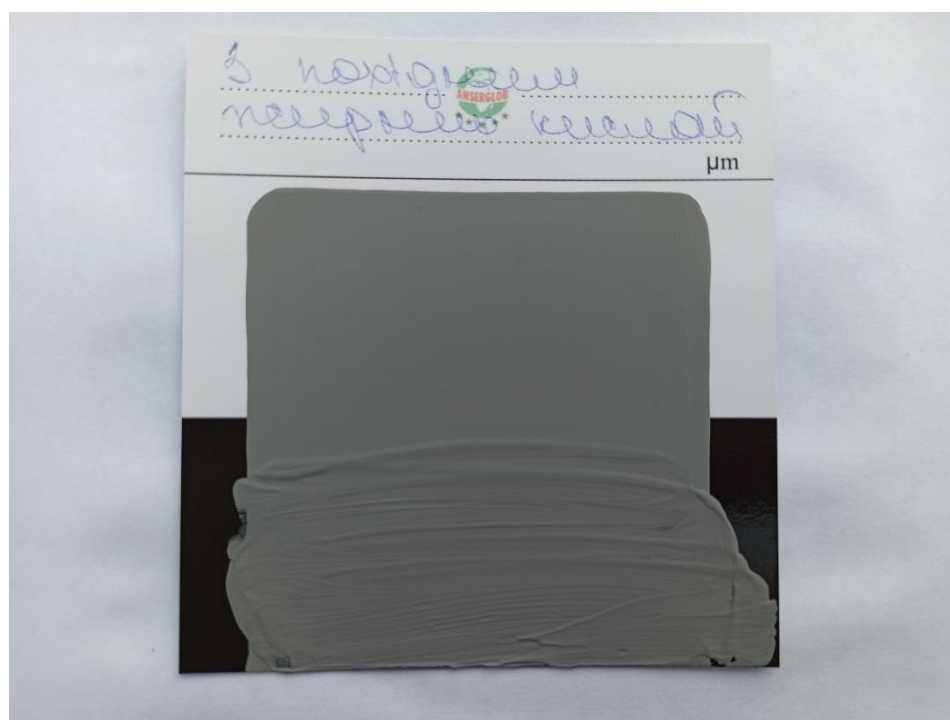
Рисунок 3.10. Нанесена на картку паста, на основі похідних жирних кислот
