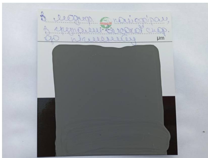
Рисунок 3.6. Нанесена на картку паста, на основі модифікованого полієфіру
