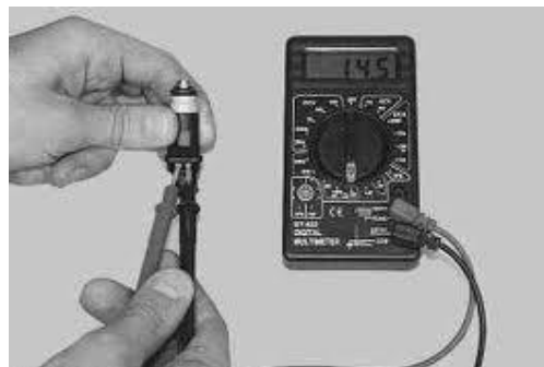
Рис. 2.2. Вимірювання опору електромагнітної форсунки
