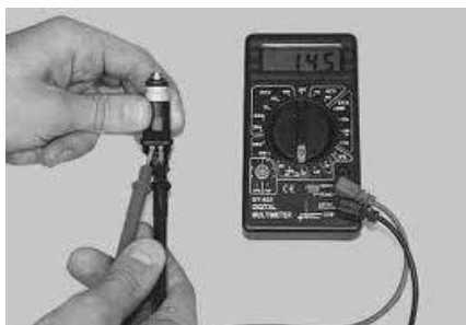
Рис. 2.4. - Вимірювання опору електромагнітної форсунки
