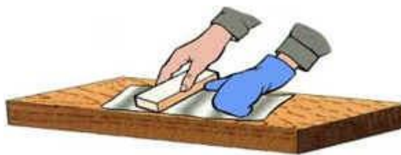
Рисунок 2.10. - Рівняння фольги дерев'яним брусом
