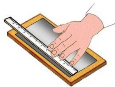
Рисунок 2.16- Інструментальна перевірка шаблону
