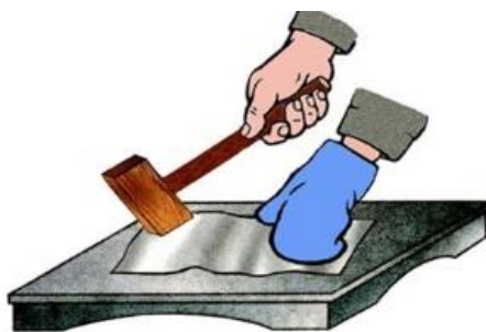
Рисунок 2.14. - Виправлення заготівлі тонколистового металу
