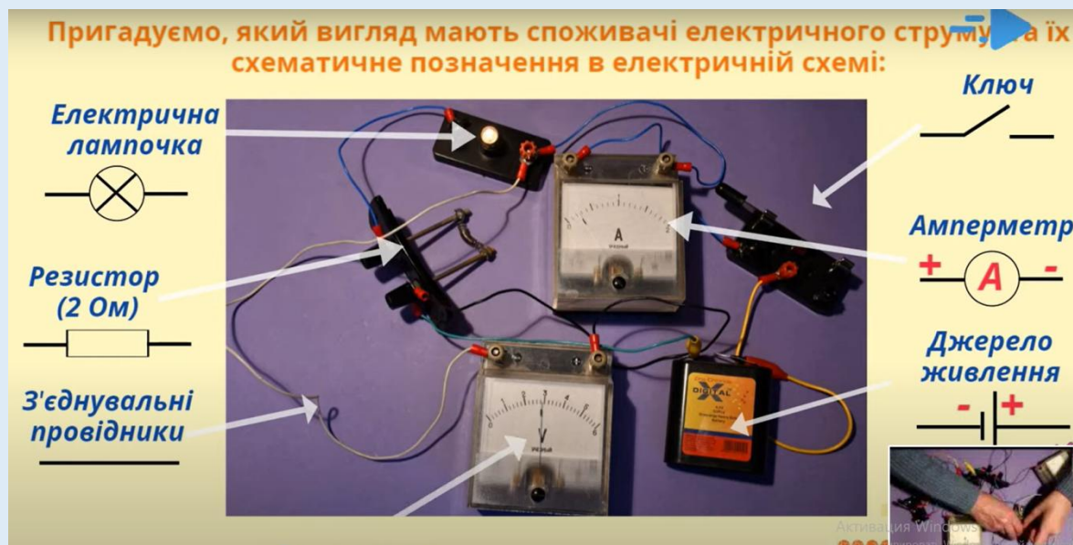
Рис. 2.7. Знімок екрану сайту лабораторної роботи «Дослідження електричного кола з послідовним з'єднанням провідників»
