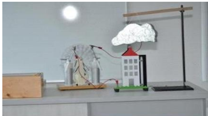
Рисунок 2.14 – Модель будинку з блискавковідводом
