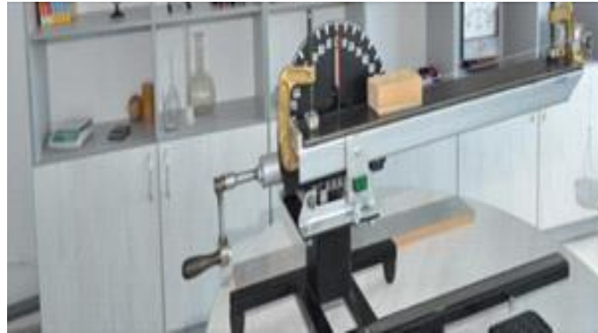
Рисунок 2.12 – Прилад для дослідження явища тертя ковзання.
