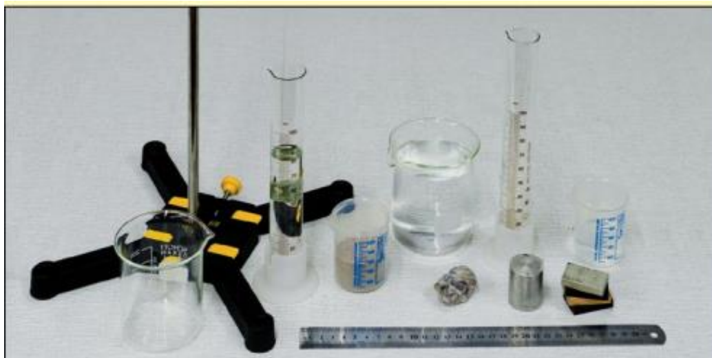
Рис. 2.2. Вимірювання об'єму твердих тіл, рідин і сипких матеріалів різними способами [40]
