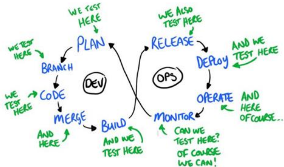
Рис. 2.3.3.1 Етапи розробки програмного продукту, на яких проводиться безперервне тестування
