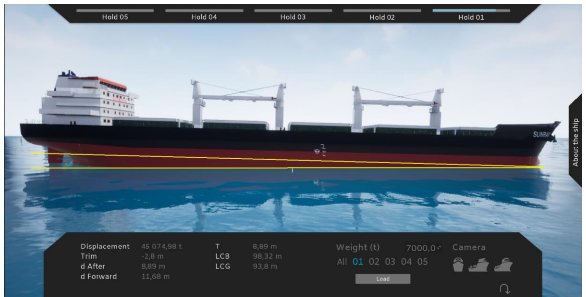
Рисунок 3.5 Трім на ніс судна
