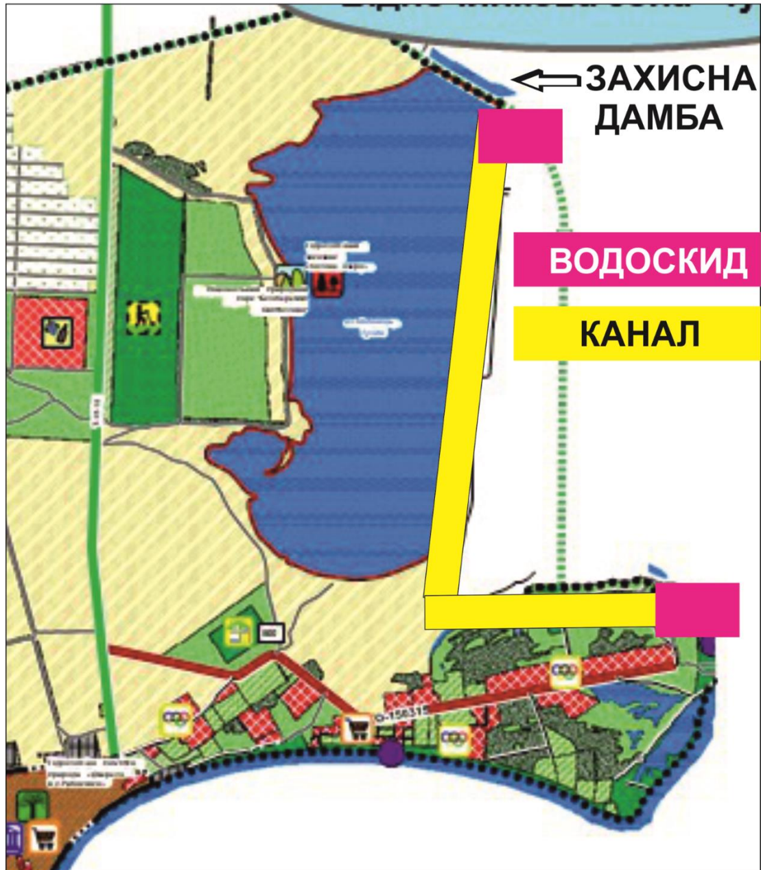
Рис. 3.5. Схема відновлення водопостачання та водовідведення в межах рекреаційного пункту «На Солі» (сайт Коблевської ОТГ).
