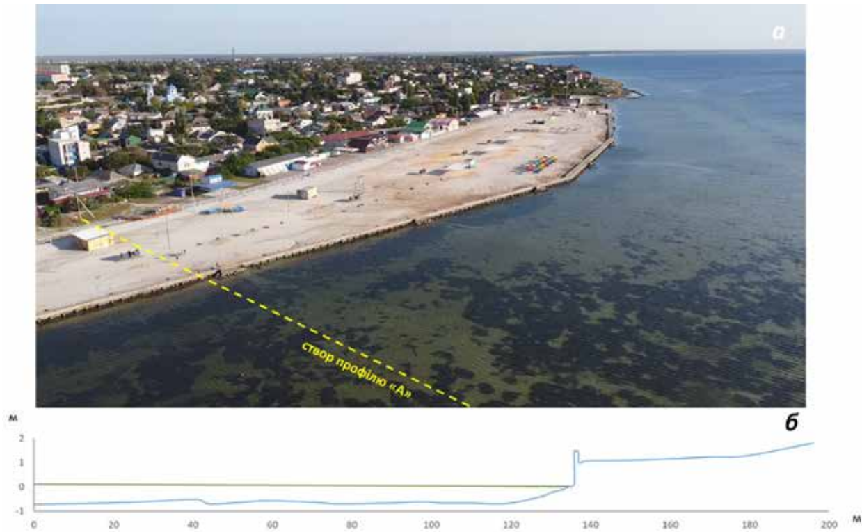
Рис. 5. Профіль «А» берегової зони Утлюцького лиману в межах південної частини «Міського пляжу»: а – просторове розташування; б – геоморфологічний профіль (фото О. Давидова)
