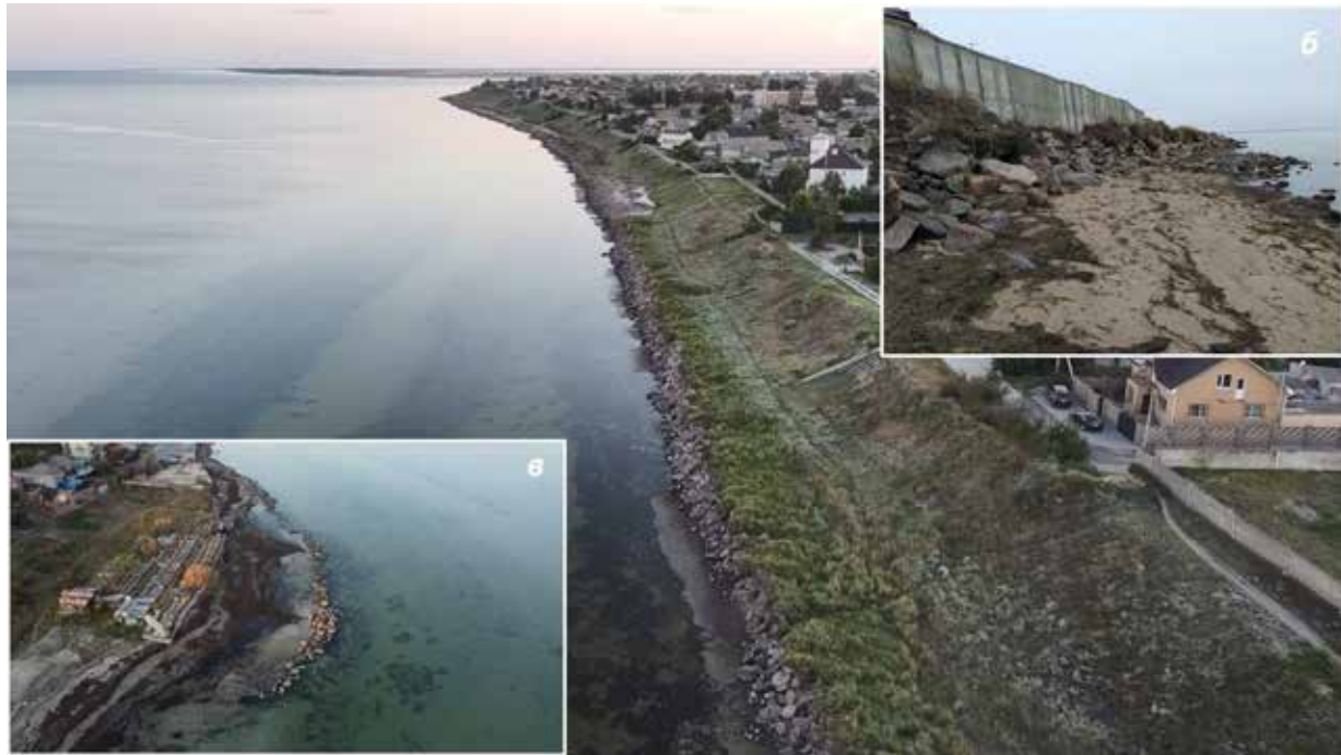
Рис. 4. Берегозахисний комплекс вздовж берега міста Генічеська: а – береговий банкет; б – хвилевідбійна стінка; в – морський банкет (фото О. Давидова)
