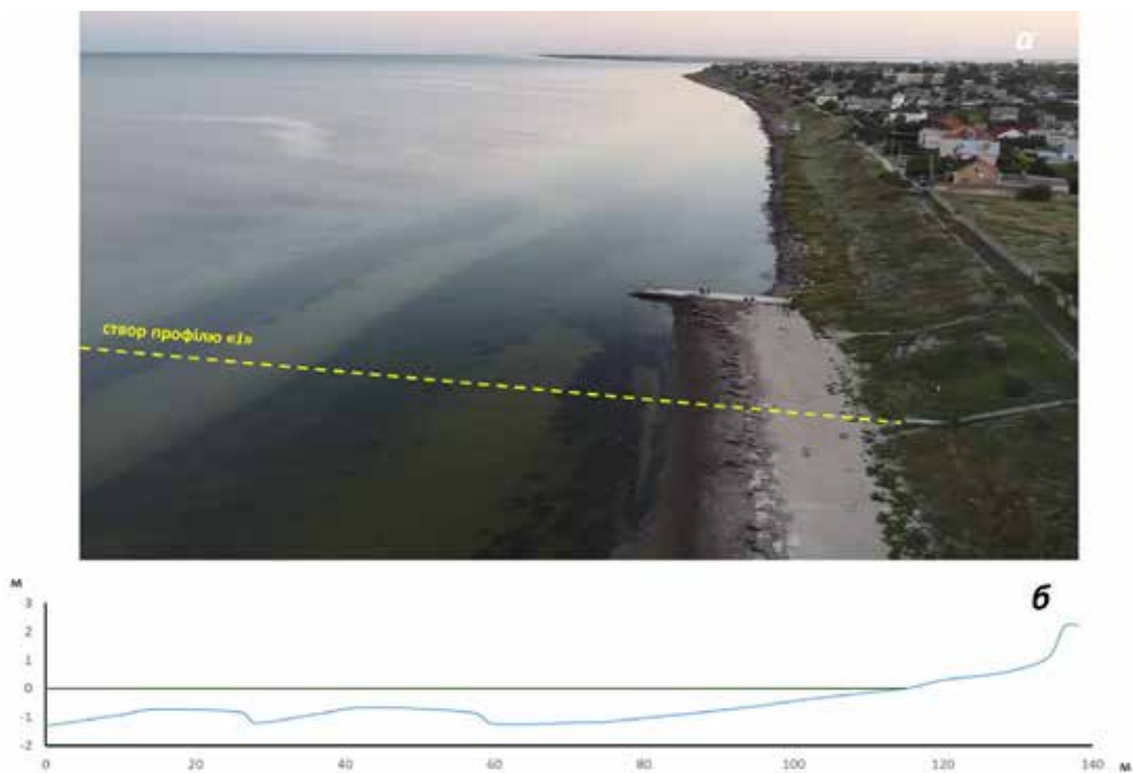
Рис. 14. Розташування профілю «J» в межах берегової зони Утлюцького лиману на північ від берегової повздожньої кам'яної накидки, за «стихійною» бунною, біля бази «Гюнай»
