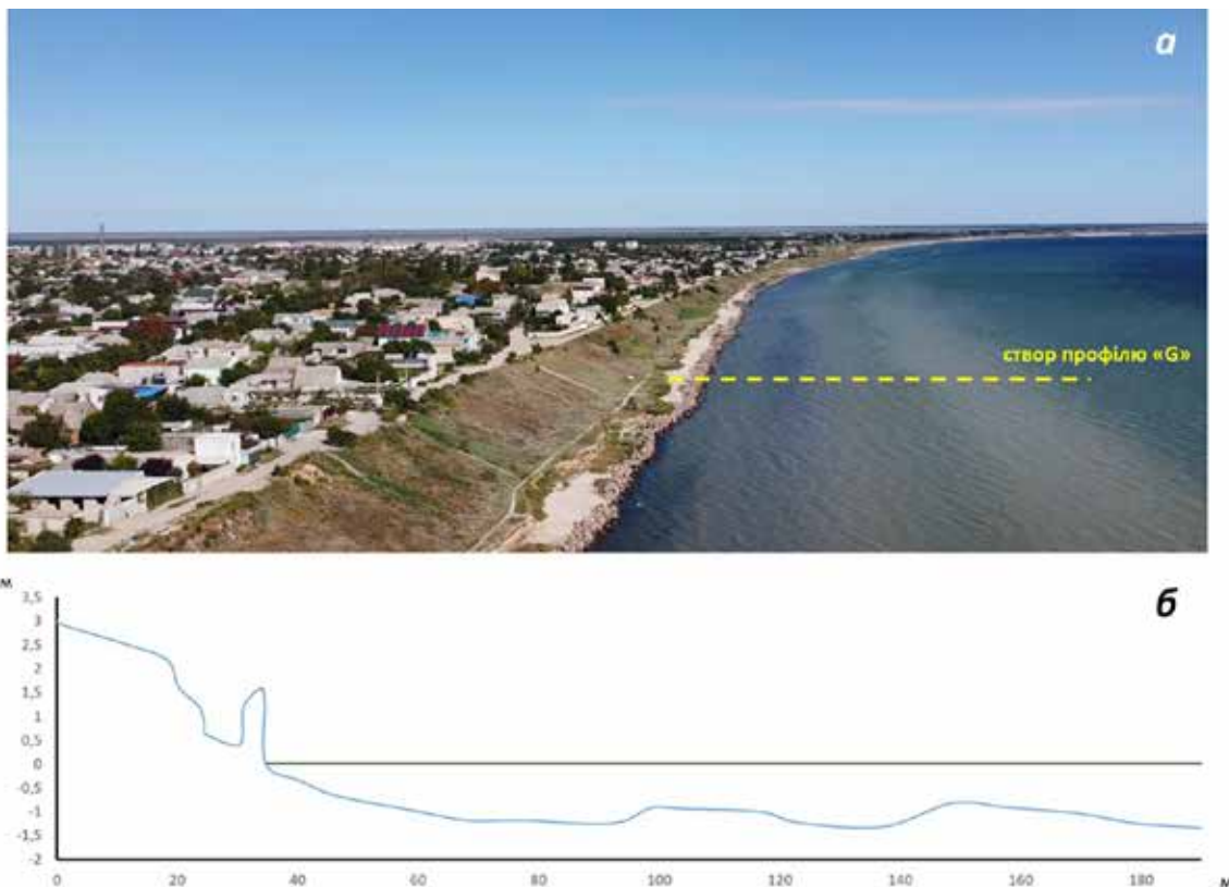
Рис. 11. Профіль «Г» у межах берегової зони Утлюцького лиману: а – просторове розташування; б – геоморфологічний профіль (фото О. Давидова)
