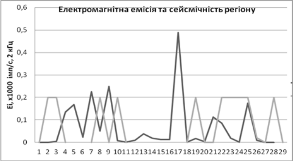
Рис. 1.2.: а) електромагнітна емісія в діапазоні 2 кГц (крива чорного кольору), сейсмічність (діаграма сірого кольору) Закарпатського внутрішнього прогину в лютому 2017 року; б) електромагнітна емісія (крива чорного кольору), сейсмічність (крива сірого кольору), сучасні горизонтальні рухи кори (пунктирна крива). Лютий 2017 року. РГС «Тросник», ПДС «Королево»
