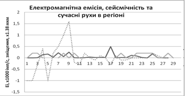
Рис. 1.2.: а) електромагнітна емісія в діапазоні 2 кГц (крива чорного кольору), сейсмічність (діаграма сірого кольору) Закарпатського внутрішнього прогину в лютому 2017 року; б) електромагнітна емісія (крива чорного кольору), сейсмічність (крива сірого кольору), сучасні горизонтальні рухи кори (пунктирна крива). Лютий 2017 року. РГС «Тросник», ПДС «Королево»
