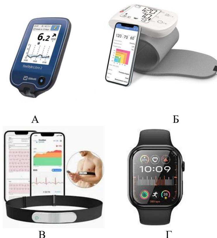
Рис. 4.2 - Приклади приладів дистанційного моніторингу: А - глюкометр, Б - тонометр, В - датчик ЕКГ, Г - смарт-годинник
