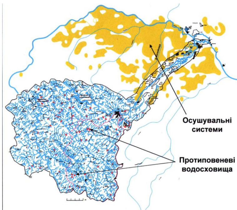
Рис.10 – Регіональна типова схема захисту сільських територій від повеней і паводків у Карпатському регіоні [14,15,16,17].
