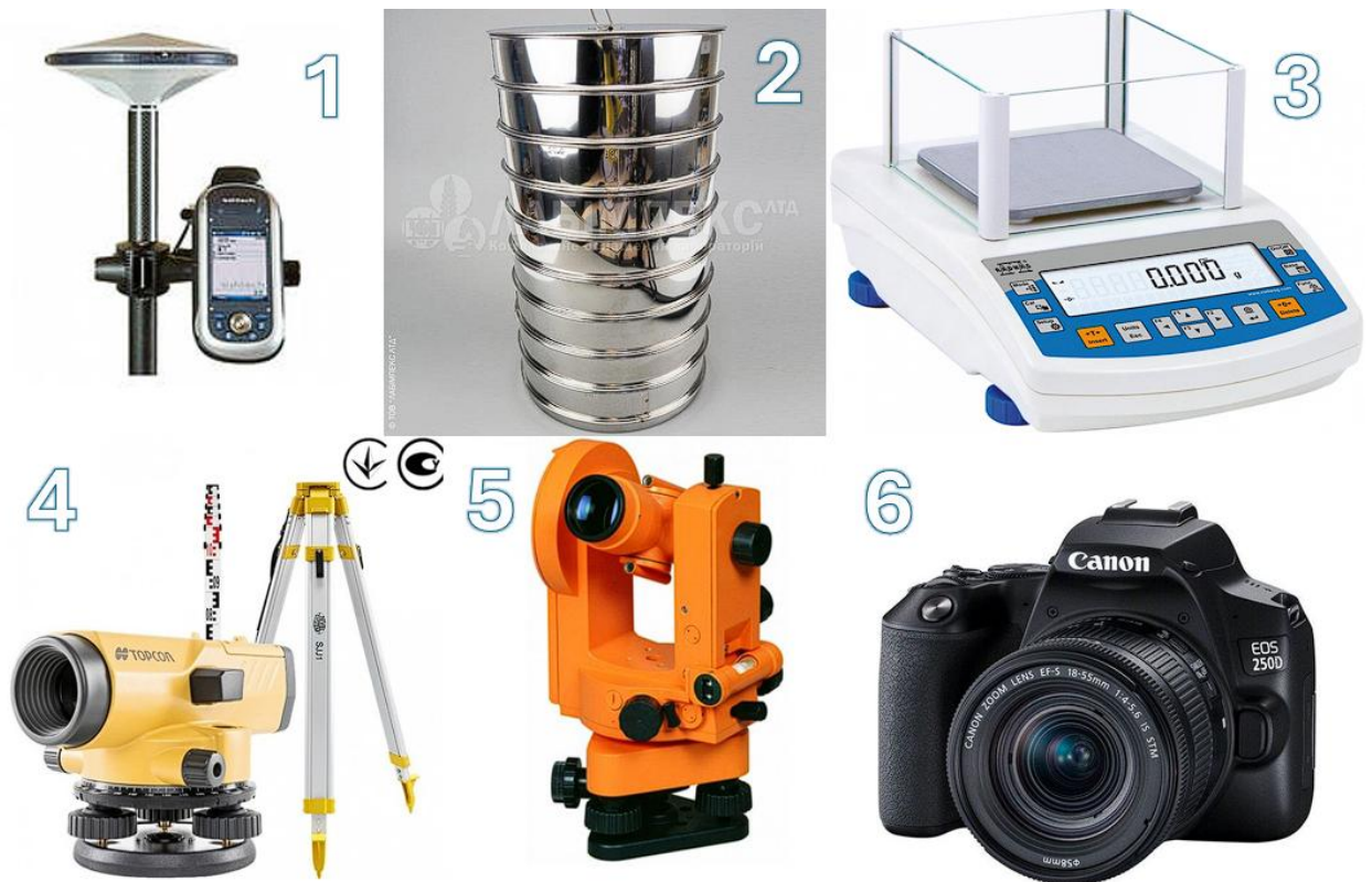
Рис. 2.1 – Прилади та обладнання які використовують під час польових робіт: 1) GPS-приймач; 2) набір геологічних сит; 3) електронні лабораторні ваги; 4) оптичний нівелір, штатив та рейка; 5) теодоліт; 6) фотоапарат.
