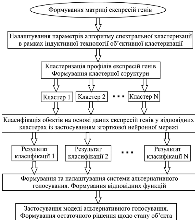
Рис. 4.24. Блок-схема інформаційної технології діагностики складних об'єктів на основі даних експресії генів із застосуванням алгоритму спектральної кластеризації, ЗНМ та методу альтернативного голосування
