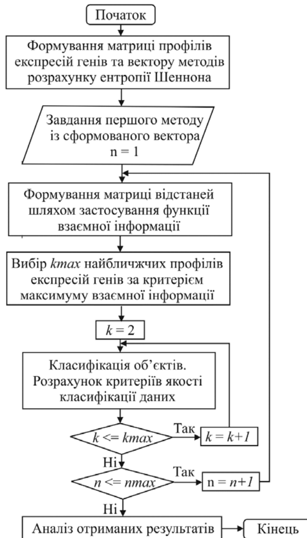
Рис. 2.2. Блок-схема алгоритму оцінки ефективності методу МВІ при застосуванні різних методів розрахунку ентропії Шеннона
