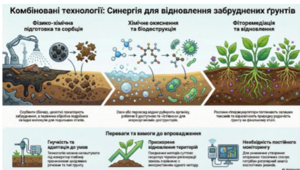
Рис 2.6. Поєднання фізико-хімічних методів відновлення забруднених ґрунтів
