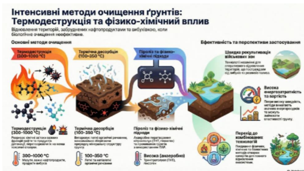
Рис 2.3. Схема термодеструкційних та інших фізико-хімічних методів очищення ґрунтів
