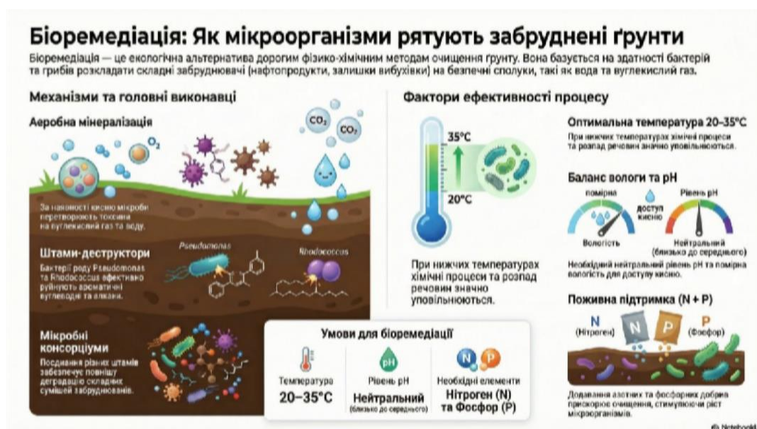
Рис 2.1. Схема роботи біоремедіації в забруднених ґрунтах
