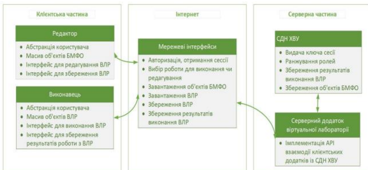
Рис. 2.2. Структура системи віртуальної фізичної лабораторії
