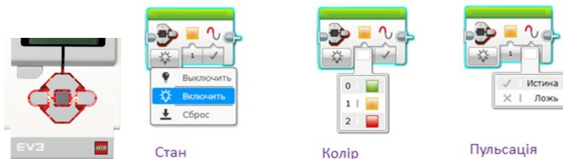
Рис.10 Індикатор стану модуля EV3
