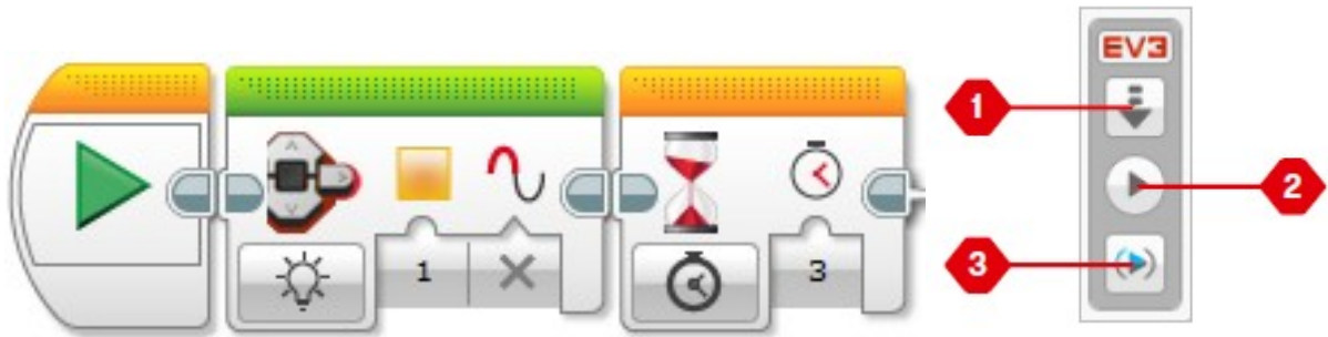
Рис.11 Приклад програми роботи індикатора стану і команди запуску програми на виконання
