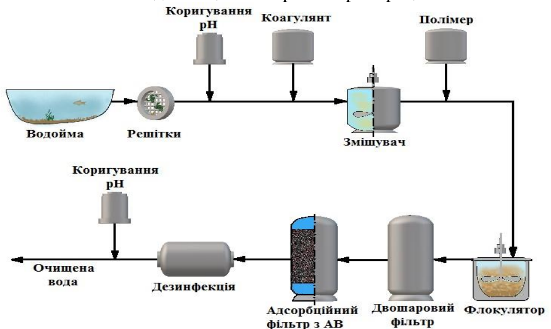
Рисунок 2.11 – Схема водоочищення з контактною коагуляцією.
