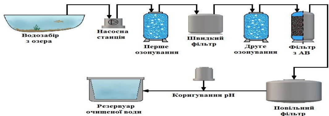
Рисунок 2.2 – Схема підготовки питної води з Цюріхського озера.
