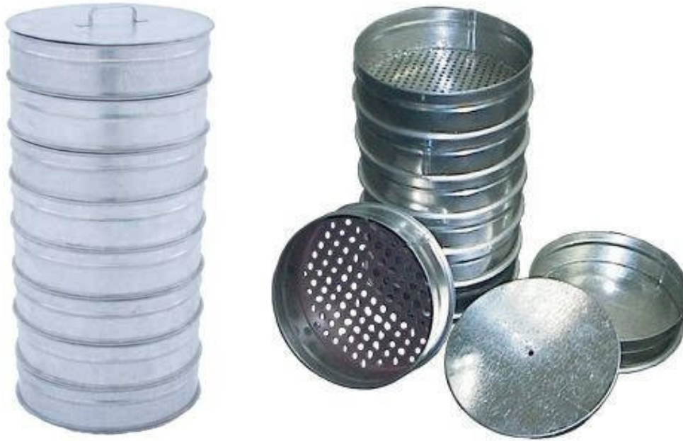
Рис. 24. Сита для визначення механічного складу ґрунту: а – у складеному стані, б – фото ( https://spectrolab.com.ua/ua/p24431657-komplekt-sit-ksi.html ).
