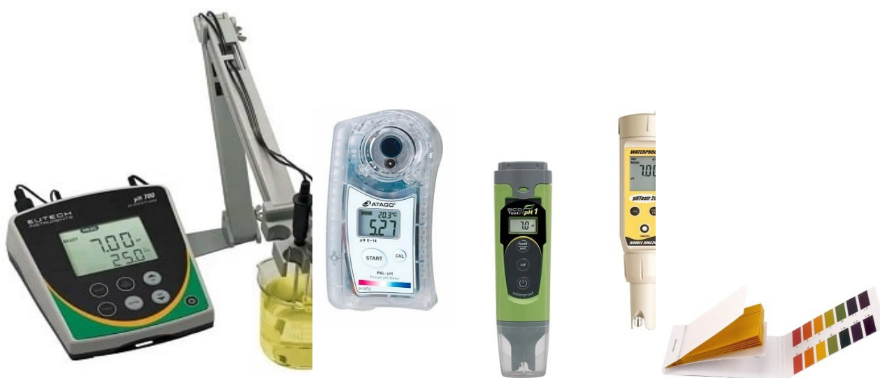
Рис. 28. Засоби для визначення рН ( https://ventalab.ua/shcho-take-ph-vody-ta-yak-yoho-vymiryaty ): а – лабораторний рН-метр; б – ручні рН-метри; в – тест-смужки (лакмусові смужки).
