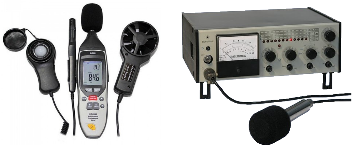
Рис. 34. Шумоміри: а – Шумомір (5 у 1) СЕМ DT-859B-1270-00219 ( https://ksu24.kspu.edu/s/42Ooc ); б – Шумомір ВШВ-003 ( https://ksu24.kspu.edu/s/undefined ). Шумоміри, як правило, складаються з датчика (мікрофона), підсилювача та вимірювального пристрою і мають частотні (“Лін”, “А”, “С”) та часові (“F” – швидко, “S” – повільно, “I” – імпульс) характеристики.
