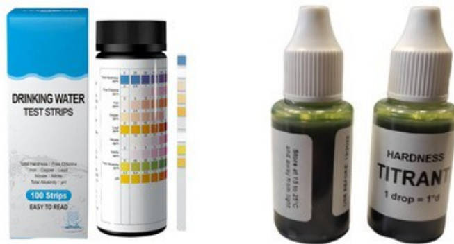
Рис. 29. Прості тести для визначення жорсткості води: а – тест-смужки для визначення якості води ( https://ksu24.kspu.edu/s/undefined ); б – універсальний тест для визначення жорсткості води ( https://ksu24.kspu.edu/s/W8bu7 ).
