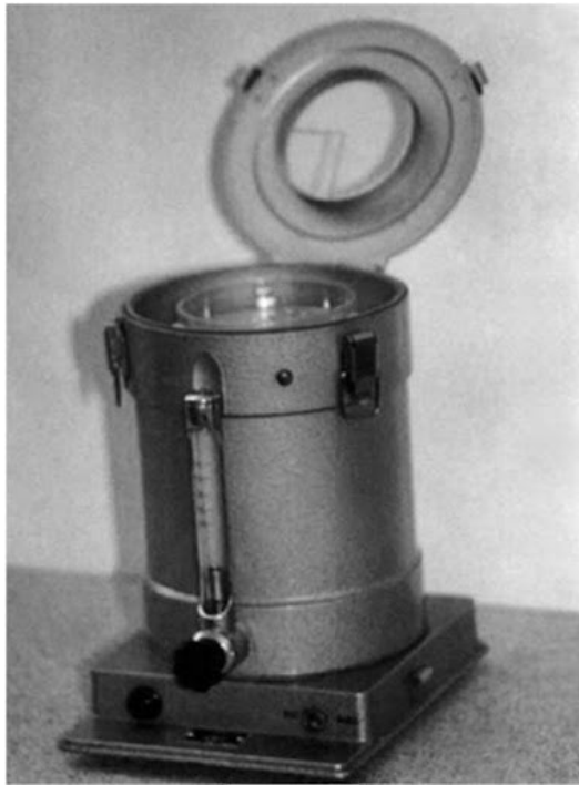
Рис. 6. Прилад Кротова для бактеріологічного дослідження повітря (Бардов В.Г., 2017): а – фото ( https://ksu24.kspu.edu/s/7ZnZY ); б – схематичне зображення ( https://ksu24.kspu.edu/s/cSzUt ): 1 – клиновидна щілина (ширина 0,1 мм біля центру), 2 – обертальний диск, 3 – ротаметр.
