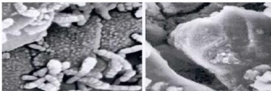
Рис. 3.3. Мікроскопічний вигляд іммобілізованих гранул (1) прошарок між фосфогіпсом та іммобілізованим носієм; (2) мікроскопічний вигляд клітин із шару носія
