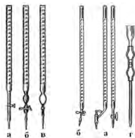
Бюретки: а – з краном; б – із затискачем Мора; в – зі скляною кулькою; г – гумова насадка для бюреток Застосовуються для процесів титрування
