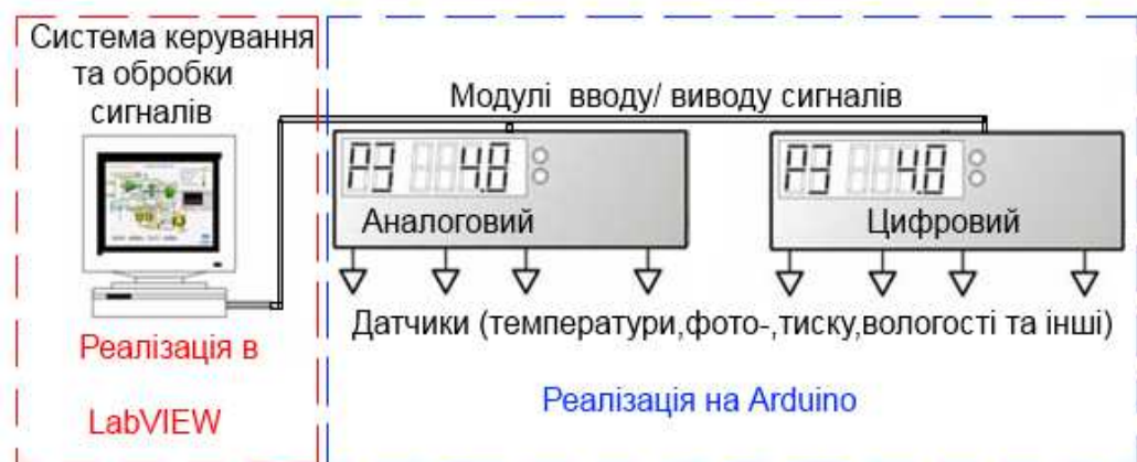
Рисунок 1. Функціональна схема автоматичної системи вимірювання параметрів мікроклімату
