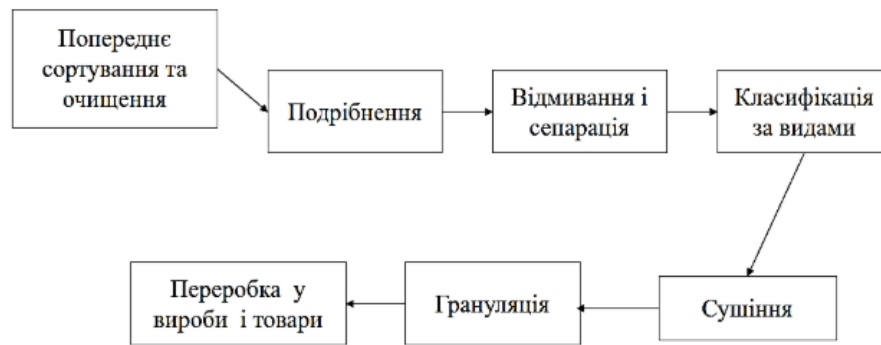
Рисунок 1.6 Схема переробки полімерних виробів
