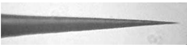
Рис.6. Зонд, полученный с автоматической отсечкой тока
