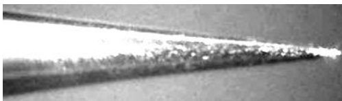
Рис.2. Зонд, полученный травлением в капле
