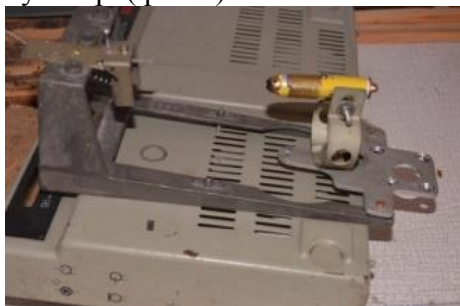
Рис.6. Статичні випробування консольної балки на згин з використанням дзеркального кутоміра.
