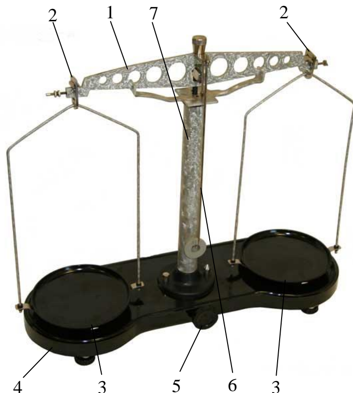
Рис. 2.1.5. Технічні терези Т-200
