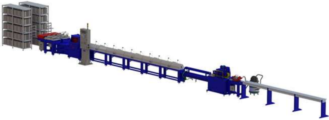
Рисунок 2. Линия для изготовления стекловолоконной арматуры
