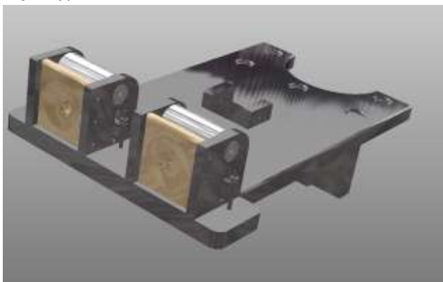
Рисунок 7. - Приспособление для наматывания стекловолоконной нити
