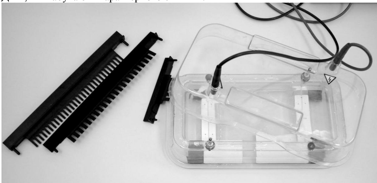
Рис. 3.6. – Електрофорезна камера з гребінками (ліворуч), які після застигання гелю формують лунки
