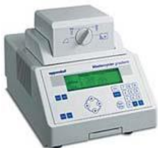
Рис. 3.8. - Ампліфікатор – прилад, що забезпечує періодичне охолодження та нагрівання пробірок, необхідне для проведення ПЛР
