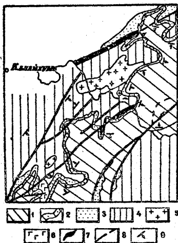
Рис. 41. Схема геологического строения Курговладского района 1-нижняя пермь (пшихарвская свита); 2-средний-верхний карбон (курговладская свита); 3-нижний-средний карбон; 4-докембрий; 5-гранитоиды; 6-диориты; 7 - ультрабазиты; 8 -разрывные нарушения; 9 - наклонное залегание пластов.
