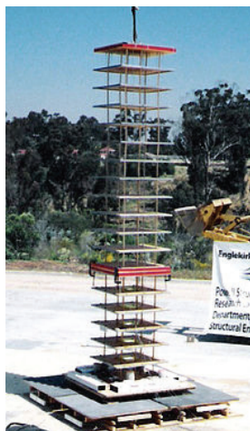
Модель 18-поверхової будівлі на сейсмопротекторі.
