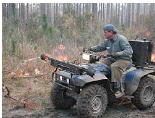
Підпалювання лісу в Південній Кароліні за допомогою спеціального спалахувача, встановленого на всюдиході.
