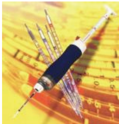
До набору газоаналізаторних трубок додається насос для прокачування повітря.
