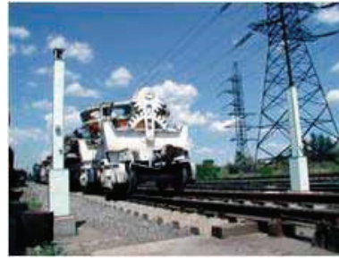
Радіометр «Кордон» в пункті пропуску залізничного транспорту.
