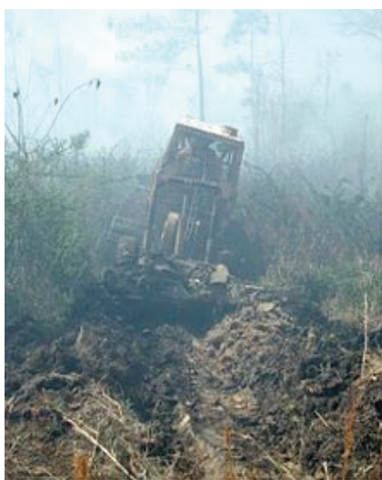
Прокладка мінералізованої смуги при відсутності доріг або просік - необхідна умова початку пуску зустрічного вогню.
