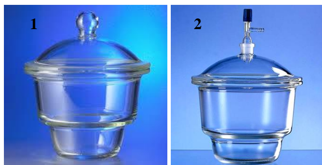
Рис. 12. Прилади для висушування та зберігання речовин: 1 – ексикатор; 2 – вакуум-ексикатор.
