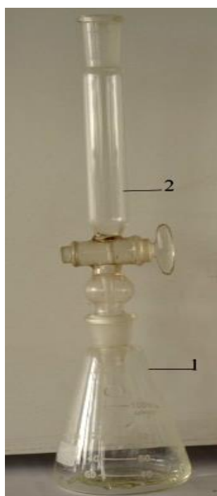
Рис. 23. Прилад для одержання еозину: 1 – конічна колба; 2 – крапельна лійка.
