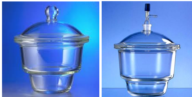
Рис. 12. Прилади для висушування та зберігання речовин: 1 – ексикатор; 2 – вакуум-ексикатор.
