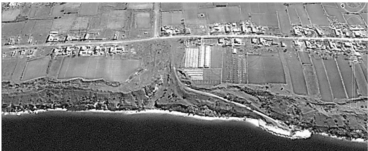
Рис.4. Зсуви на лівому березі Каховського водосховища в межах с.Мала Лепетиха (за матеріалами Google Earth - точка дослідження №3) [11].
